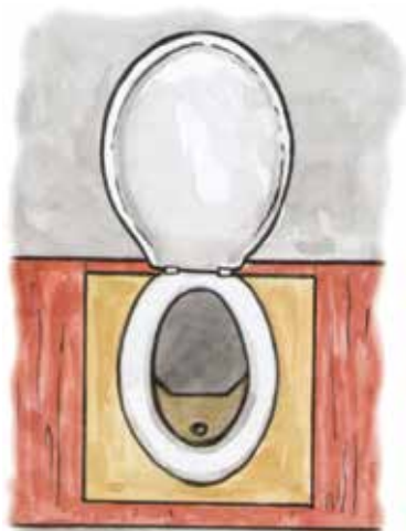
Detalhe do segregador de urina no vaso.
