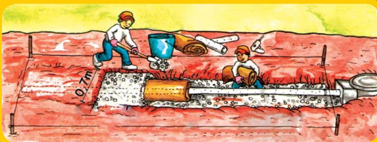
O solo deve receber um sistema de drenagem com a mesma largura e comprimento de cada leira, e profundidade de 0,25m escavada em formato de um V. O buraco recebe uma camada de brita e um cano de PVC perfurado, envolvido em uma manta impermeável. O cano deve ter uma declividade de 2% para conduzir o líquido percolado até uma caixa de concreto, podendo ser reintroduzido na própria leira ou utilizado como fertilizante líquido.
